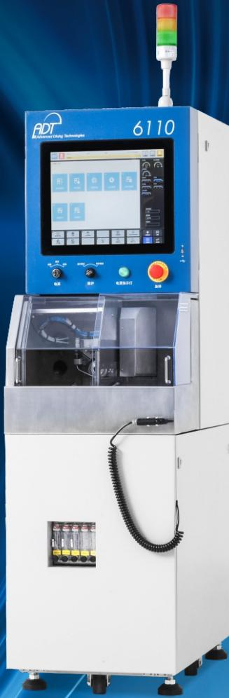
ADT6110是一款高精度，高性能单轴半自动切割机，机身宽度490mm，占地面积小到极致，结合全新设计的操作系统，提供高效，低使用成本的切割体验。
